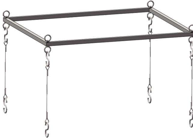
图13: MYTEX U1L膜组件的起重工具
